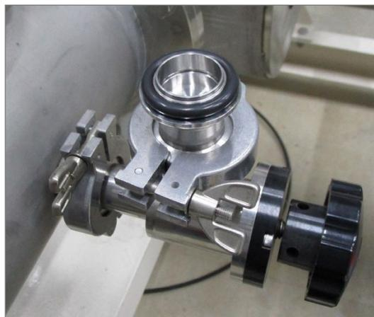
図2 残留ガス分析用のオリフィス設置。
